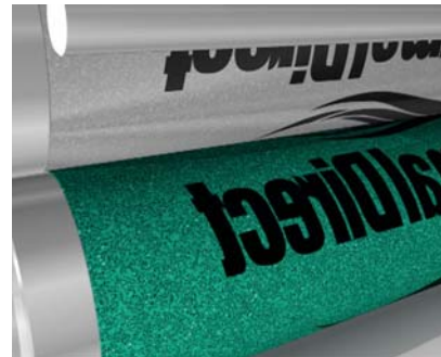
5 Tekućina za vlaženje u kombinaciji s bojom omogućava da se rastopivi dio prenese na ofsetni cilindar i zatim dalje na papir
