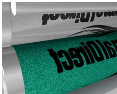
Tekućina za vlaženje u kombinaciji s bojom omogućava da se rastopivi dio prenese na ofsetni cilindar i zatim dalje na papir
